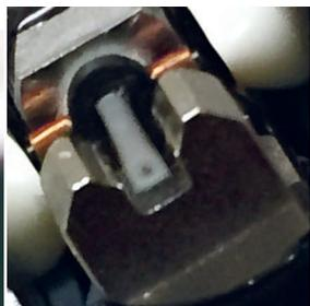
As AT33MONO, AT-MONO3/LP e AT-MONO3/SP são verdadeiras cápsulas mono devido à configuração horizontal das bobinas. A cápsula só gera sinal elétrico com movimento horizontal devido à configuração horizontal da bobina.
