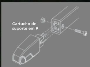
*Cápsula de suporte em P montada em um braço de suporte P (são fornecidos parafuso e porca com todos os modelos).*
